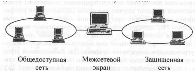
Рис.12.3. Соединение сетей с помощью межсетевого экрана
