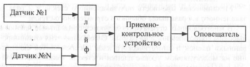
Рис.6.1. Структура типовой системы охранной сигнализации
