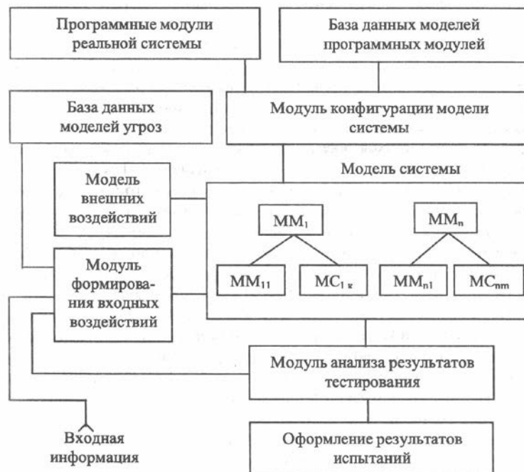
Рис.8.2. Структурная схема контрольно-испытательного стенда
